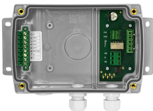
Abb. 14 ARC-Modul im Polycarbonat-Gehäuse
