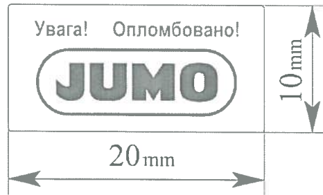
Рисунок 2 – Загальний вигляд саморуйнівної наклейки, призначеної для пломбування верхньої кришки перетворювачів з аналоговим вих
