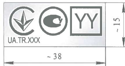
Рисунок 5 – Зразок саморуйнівної наклейки з маркуванням відповідності Figure 5 – An example of the self-destructive sticker with of conformity marking
