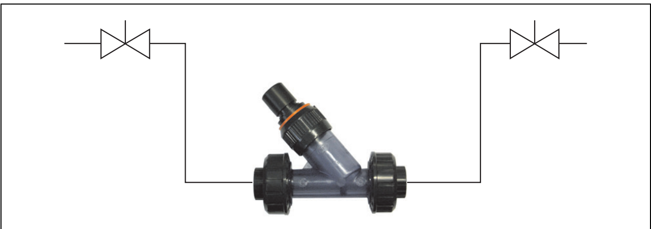
Abbildung 8: Einbaubeispiel Schrägsitzarmatur Typ 202810/01
