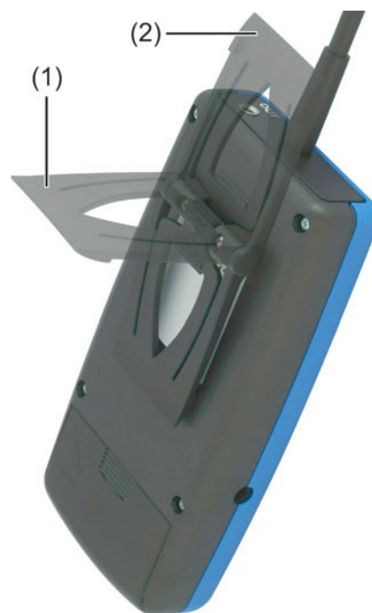
Zawias stojący ustawiony pod kątem 90°/180°
